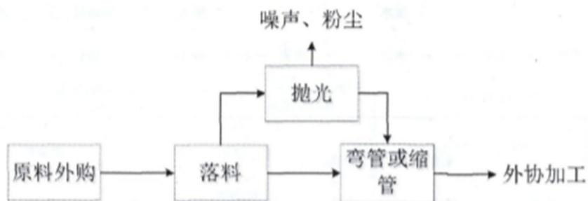
图 2.5.1-6 杭州海尚科技有限公司（2007 至今）抛光工序工艺流程图
